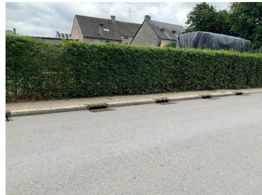
Beispiel an strategischen Stellen mehrere Einläufe positionieren.
